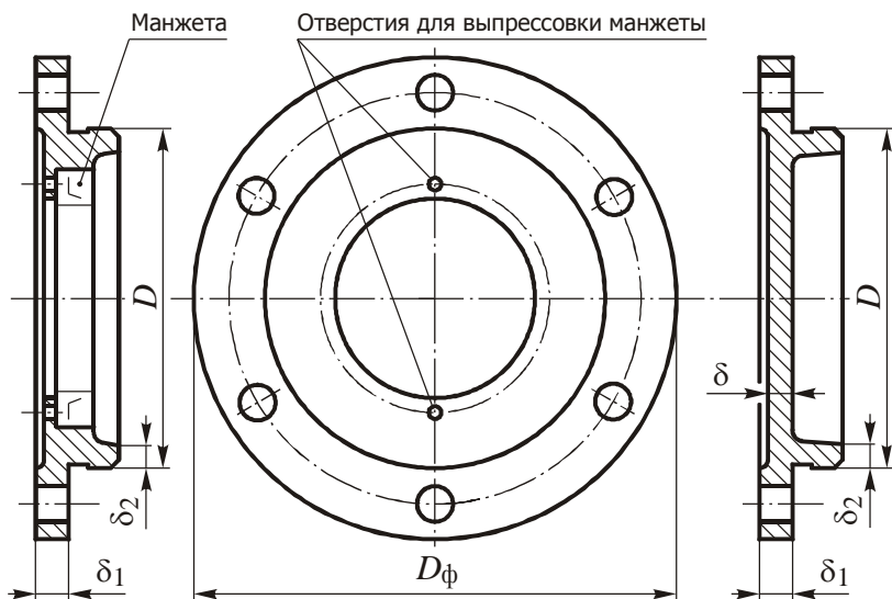
Рис. 38. Крышки подшипников: слева – сквозная, справа – глухая
